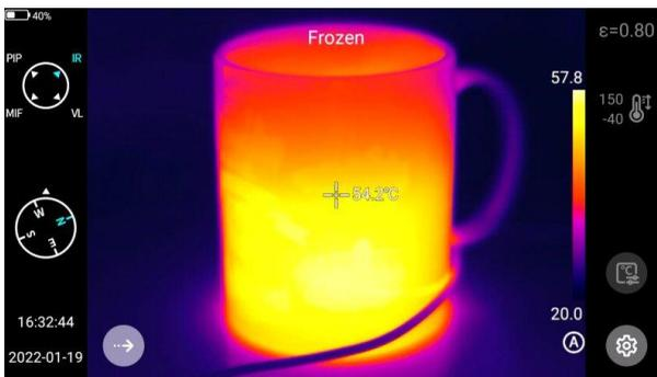
Drücken Sie die Auslösetaste. Das Bild wird wie gezeigt gestoppt („eingefroren“).
